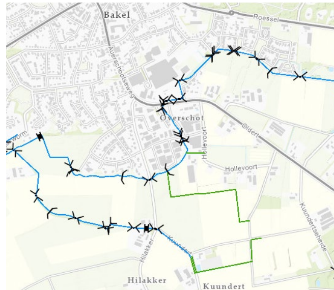
Leggerkaart met A- en B-watergangen (resp. blauw en groen) (bron: Waterschap Aa en Maas)
